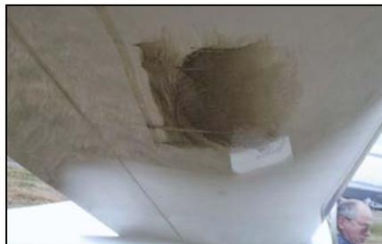
Corde 2,51 m, bande crantée temporaire installée à 0,49C (Point médian des bulles de séparations à 96 et 130 km/h).
