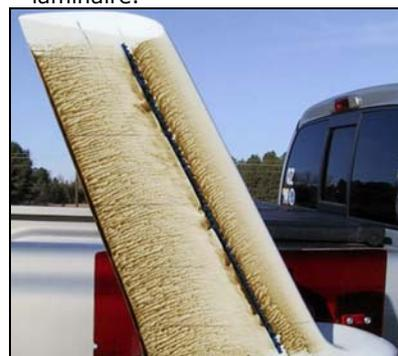
Turbulateurs placés à 6 mm derrière le début de la bulle laminaire.
