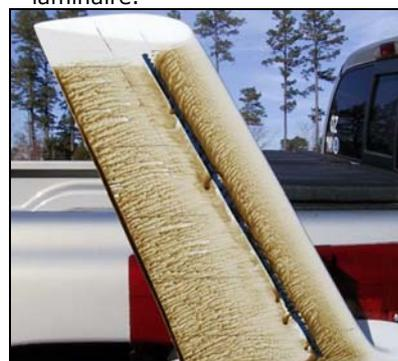
Turbulateurs placés à 13 mm derrière le début de la bulle laminaire.
