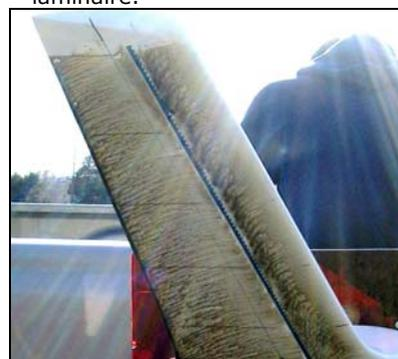
Turbulateurs placés à 25 mm derrière le début de la bulle laminaire.
