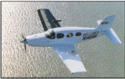
La technique qui utilise la sublimation (passage direct de l'état solide à l'état gazeux) de composants chimiques permet de repérer les zones d'écoulements laminaires et turbulents.
