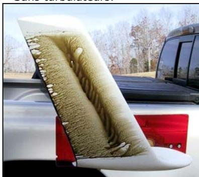
Turbulateurs placés à 6 mm devant le début de la bulle laminaire.
