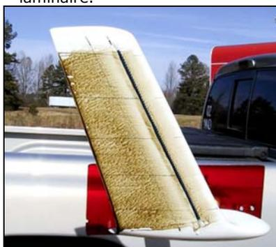
Turbulateurs placés sur le début de la bulle laminaire.
